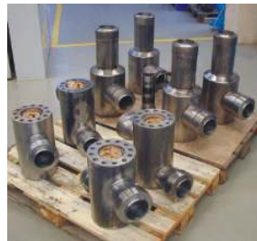
Eckventilgehäuse für Kraftwerke 3D-Stutzenschweißung
