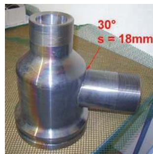
Eckventilgehäuse mit 3D-Sattelkontur 30 mm Wandstärke
