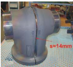
Schiebergehäuse aus Halbschalen geschweißt DN 150
