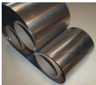
Elektronenstrahlschweißung von Förderbändern, 0,2 mm
