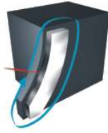
Schweißen von Platin mit Titan (Zweck: Einsparung von Platin)
