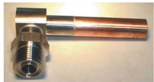
Wasseranschluss als Kupfer-Stahl-Verbindung, elektronenstrahlgeschweißt
