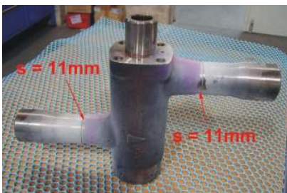
Elektronenstrahlschweißung von Stützen aus 13CrMo4
