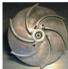
Pumpenlaufrad mit 3D-Schweißführung
