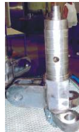
Drehgelenkträger aus StE 690, 50 mm Schweißtiefe
