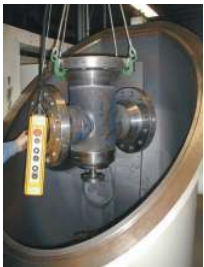
Topfilter DN 200, 3D- und Rundnähte
