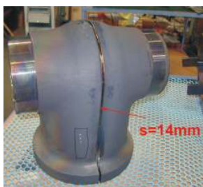
Schiebergehäuse aus Halbschalen geschweißt DN 150
