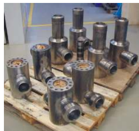
Eckventilgehäuse für Kraftwerke 3D-Stutzenschweißung
