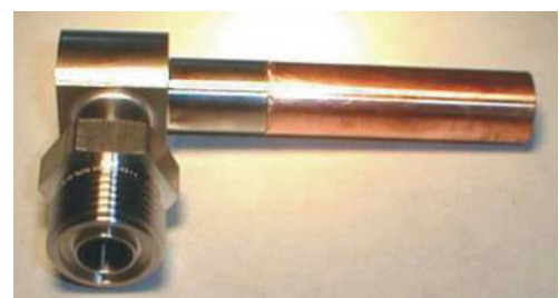
Wasseranschluss als Kupfer-Stahl-Verbindung, elektronenstrahlgeschweißt
