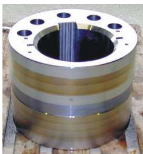
Härten einer Exzenterbuchse 0,8 mm tief, GGG 60
