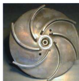
Pumpenlaufrad mit 3D-Schweißführung
