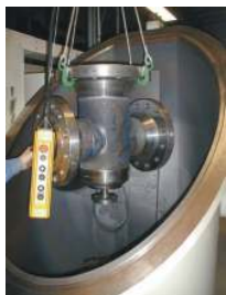
Topfilter DN 200, 3D- und Rundnähte
