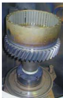
Zahnwelle für einen Planetenträger, final verschweißt
