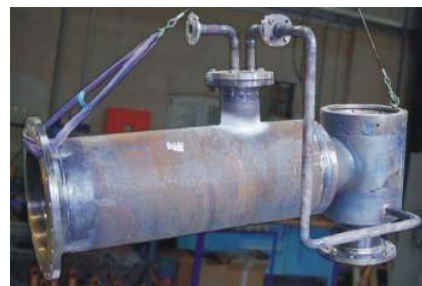
Gehäusekombination mit 2D- und 3D-Schweißnähten
