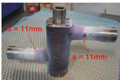
Elektronenstrahlschweißung von Stützen aus 13CrMo44
