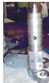
Drehgelenkträger aus StE 690, 50 mm Schweißtiefe
