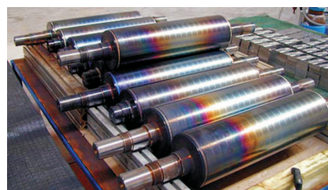
Randschicht- härten und Schweißen der Stützen in einer Aufspannung
